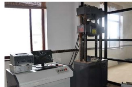
Универсальная испытательная машина
