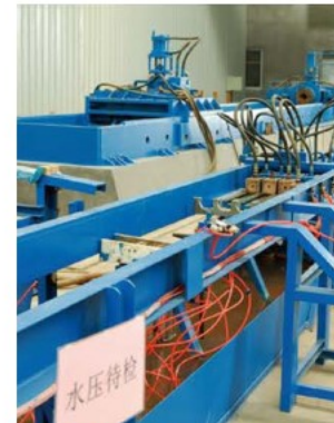
Гидравлическое испытательное оборудование
